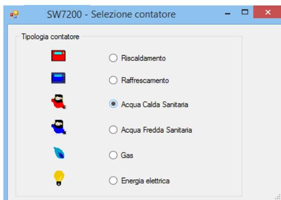
È possibile collegare all'acquisitore un solo contatore, che può essere di diverse tipologie: contatore di riscaldamento, di raffrescamento, contatore volumetrico acqua calda sanitaria, volumetrico acqua fredda sanitaria, contatore di gas o di energia elettrica.
