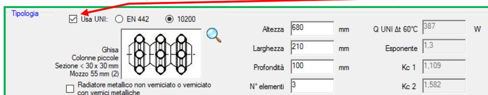
**N.B.:** la scelta fra le due tipologie (**UNI-EN442 - UNI-10200:2018**) necessaria per determinare la potenza installata del corpo scaldante, deve essere effettuata secondo le indicazioni riportate nell'appendice C della norma tecnica **10200:2018**.
